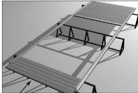
Установите второй боковой несущий профиль (2) и измерьте диагонали каркаса ворот (они должны быть равны). Прикрепите профили к каркасу с помощью заклепок (17). Расстояние между точками крепления — 100 мм.
