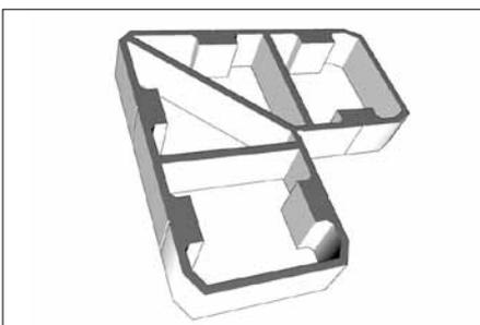
Для стыковки профилей вставьте угловые соединения щита (8).
