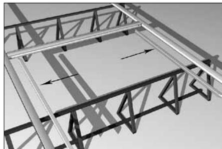
Возьмите два профиля для сборки панелей (5) и установите их на верхний и нижний несущие профили (2). Скрепите их между собой с помощью заклепок (17), предварительно просверлив отверстия сверлом  $\varnothing 4,2$  мм. Расстояние между отверстиями — 100 мм.
