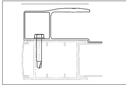
Закрепите профиль карниз ролика направляющего саморезами 5,5×32 мм со сверлом к основному несущему профилю.
