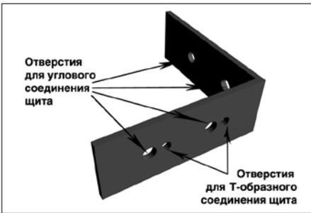
Через кондуктор (18) разметьте отверстия в промежуточном профиле (2) для крепления профиля к Т-образному соединению щита (9).
