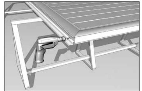
Просверлите отверстия сверлом  $\varnothing 4,2$  мм.
