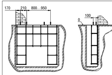
Сверху на швеллер приварите 8 болтов M16 × 100 для установки роликовых опор.
