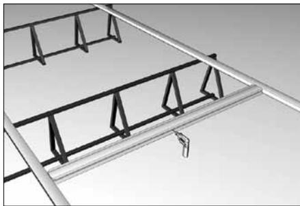
Просверлите отверстия сверлом  $\varnothing 4,2$  мм для крепления профилей для сборки панелей (5) к промежуточной стойке (основному несущему профилю (2)). Расстояние между отверстиями — 100 мм.
