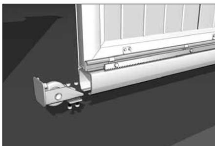
С другой стороны балки установите концевой ролик (16).
