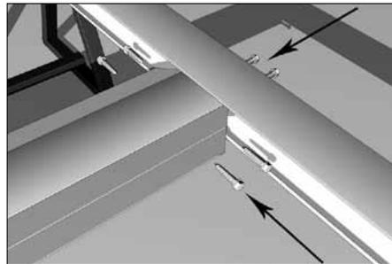
Скрепите основные несущие профили через сухарное соединение с помощью саморезов (19).
