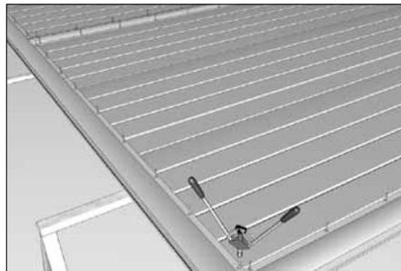
Плотно состыкуйте панели между собой и вставьте боковые профили. Скрепите панели с профилями для сборки панелей заклепками (17) с шагом 200 мм. Крепление осуществляется с внешней и внутренней стороны щита.
