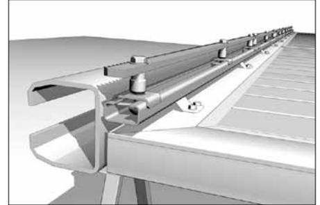
Распределите зубчатые рейки (21) по всей длине полотна ворот вплотную друг к другу. Прикрепите к рейкам стандартный крепежный комплект (22) и установите рейки на С-профиль с помощью болтов М8×25ПГ (25), закладных пластин (24) и скоб универсальных (23).
