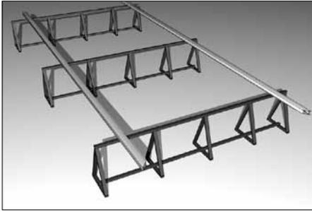
Сборку полотна сдвижных ворот необходимо производить на ровной горизонтальной поверхности. Это могут быть стол или ступени. Возьмите верхний и нижний основной несущий профили (2) — два длинных профиля и положите их на ступени.
