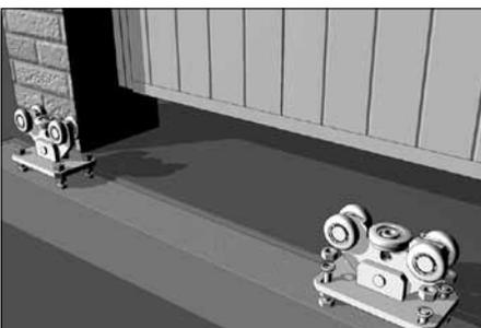
Закрепите опоры (11) с помощью гаек M16.
