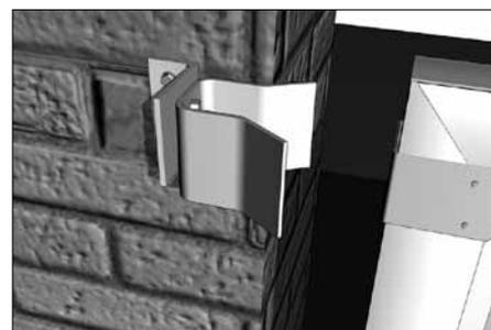
На полотно ворот установите защитную металлическую накладку (17) и закрепите с помощью заклепок.
