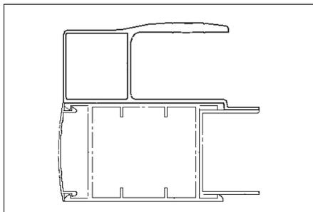
Установите профиль карниз ролика направляющего на верхний несущий профиль ворот, таким образом что бы выборка профиля карниза ролика направляющего встала на профиль для сборки панелей.
