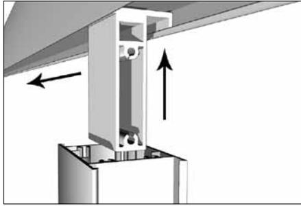
Возьмите промежуточный основной несущий профиль (2) и состыкуйте его с верхним и нижним несущими профилями (2) при помощи T-образного соединения щита (9) ворот DoorHan.
