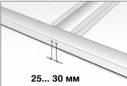
Просверлите отверстия сверлом  $\varnothing 15$  мм в верхнем и нижнем несущих профилях.
