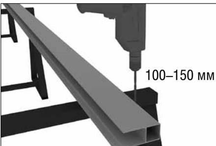
Возьмите профиль карниз ролика направляющего (7), отметьте места под отверстия в лицевой стенке профиля по всей длине профиля. сверлом  $\varnothing 13,5$ , с отступом от края 100–150 мм. Просверлите отверстия с шагом не более 300 мм.
