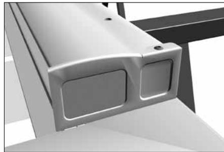
Установите боковые крышки на профиль карниз ролика направляющего. Закрепите крышки при помощи заклепок.
