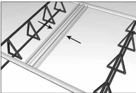
Установите на промежуточный несущий профиль (2) два профиля для сборки панелей (5).
