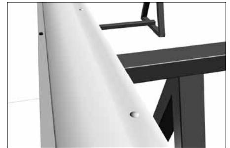
Установите декоративные заглушки на профиль карниз ролика направляющего.
