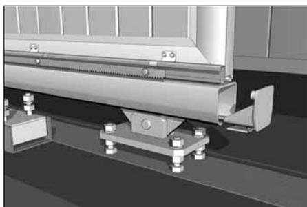
Установите заднюю крышку балки (14).
