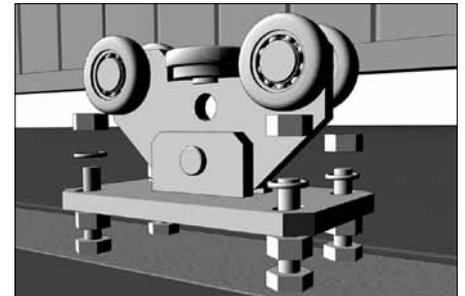
Установите на болты M16 × 100 роликовые опоры (11).
