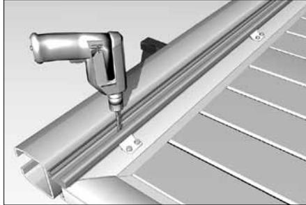
Закрепите С-профиль (26) при помощи саморезов (19), предварительно просверлив отверстия сверлом  $\varnothing 4,2$  мм.
