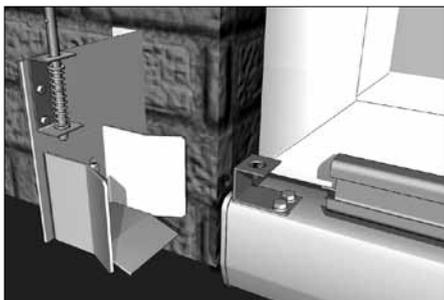
С помощью саморезов по металлу (19) закрепите проставку под задвижку ловителя (20) на балке (1).
