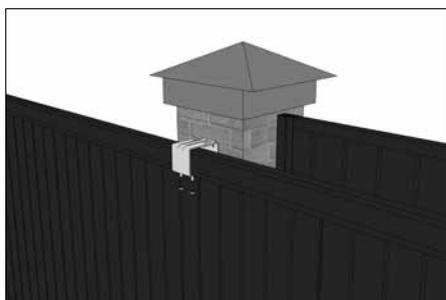
Отрегулируйте ролики направляющих устройств (16) таким образом, чтобы зазор между ними и полотном ворот составлял 1–1,5 мм.
