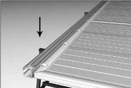
Если на сдвижные ворота будет устанавливаться электропривод, необходимо прикрепить к полотну ворот зубчатую рейку (21). Возьмите С-профиль (26), предназначенный для установки зубчатой рейки электропривода, и установите его на кронштейны крепления щита к балке (7) по всей длине полотна ворот.
