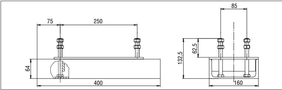
Приварите к швеллеру головки болтов и металлические пластины.
