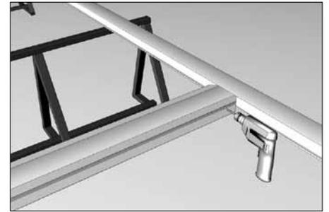
Просверлите отверстия сверлом  $\varnothing 4,2$  мм в промежуточном профиле (2).
