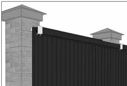
Установите полотно ворот на роликовые опоры. Отрегулируйте опоры таким образом, чтобы полотно ворот стояло без перекосов (по уровню). Зазор между нулевой отметкой и нижней частью полотна сдвижных ворот должен составлять 100...140 мм.
