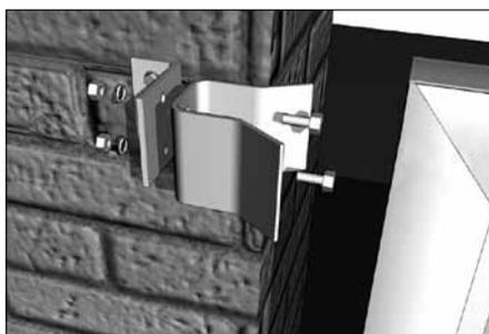
Просверлите два отверстия и прикрепите к кронштейну верхний ловитель (13) с помощью болтов и гаек.
