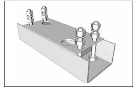
Возьмите из комплекта электропривода 8 гаек и 4 шайбы и накрутите их на болты.
