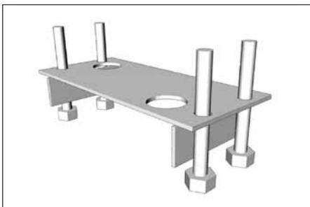
Приварите к болтам две металлические пластины 40×8 длиной 142 мм.
