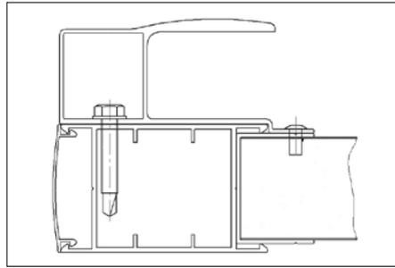
Закрепите профиль карниз ролика направляющего к профилю для сборки панелей заклепками (12) с шагом 300 мм.
