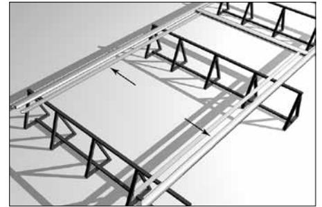
Проверьте точность стыковки углов профилей и отсутствие зазоров между соединениями. Прикрепите профили для сборки панелей (5) к верхнему и нижнему несущему профилям (2) с помощью заклепок (17). Расстояние между точками крепления — 100 мм.
