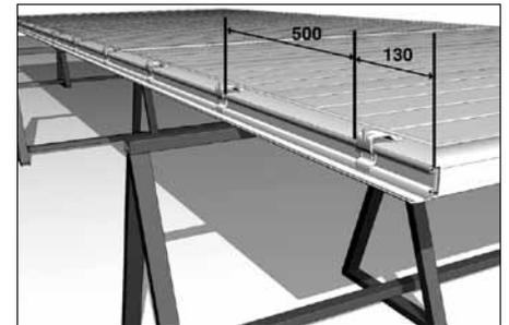
Разместите на нижней части щита стальные оцинкованные кронштейны крепления щита к балке (7). Расстояние от края балки (1) до кронштейна должно составлять 130 мм. Между кронштейнами — 500 мм.
