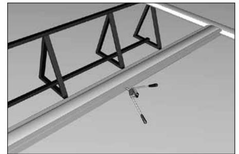
Закрепите профили с помощью заклепок (17) и клепателя.
