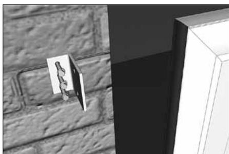
С противоположной стороны проема (на столбе ограждения) закрепите кронштейн крепления верхнего ловителя.
