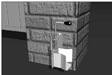
На кронштейн нижнего ловителя с помощью саморезов по металлу (19) прикрепите задвижку (10).
